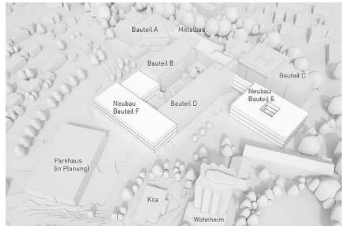
Die aktuelle Planung der Baumaßnahmen: Mittelbau plus Bauteil A bis D bilden den Bestand. In Bauplanung befindet sich das Bettenhaus E und ein Funktionsgebäude F sowie das Parkhaus.
